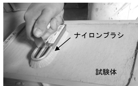
写真-1 粉体の採取の方法
