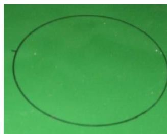
写真 4 左: 真空脱水工法ふくれ無し
